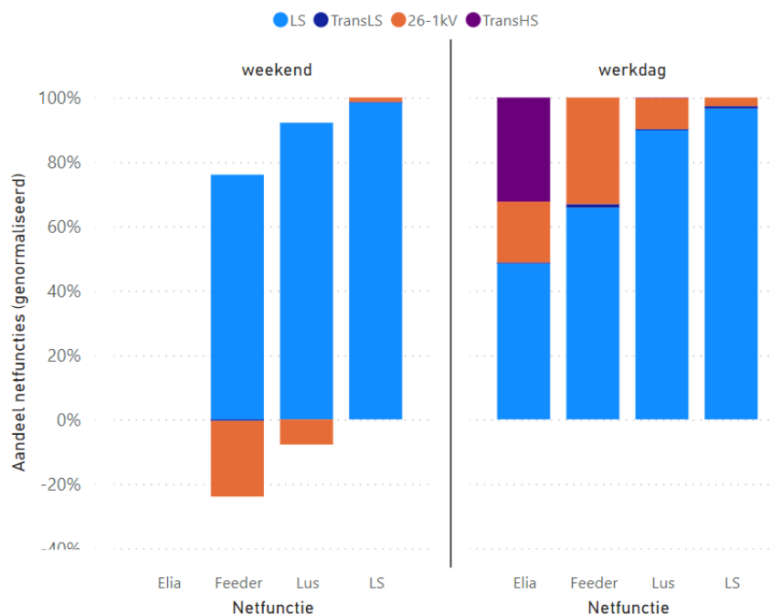
Figuur 50: De genormaliseerde kostenimpact per netvlak, opgedeeld in werkdag en weekend om 16.00 uur voor netassets met een jaarpiek afname. In het weekend is klantengroep 26-1kV collectief aan het produceren, waardoor ze netto-consumptie van laagspanning afneemt. Uiteindelijk waren er geen jaarpieken afname te registeren in het weekend op niveau koppelpunt Elia, dankzij lokale zelfconsumptie.
